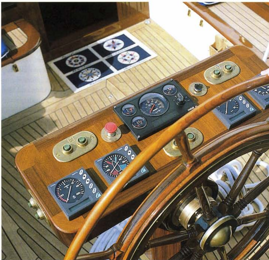
Op het grote stuurconsole zijn alle meters (nog niet aangesloten ten tijde van de proefvaart) en de knoppen voor zwaardlieren en schootlieren. Met de rode knop kunnen alle hydraulische systemen direct worden gestopt.
