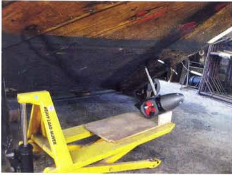
boven: Eerst passen en meten. Een lange pen moet door de stevenbalk
