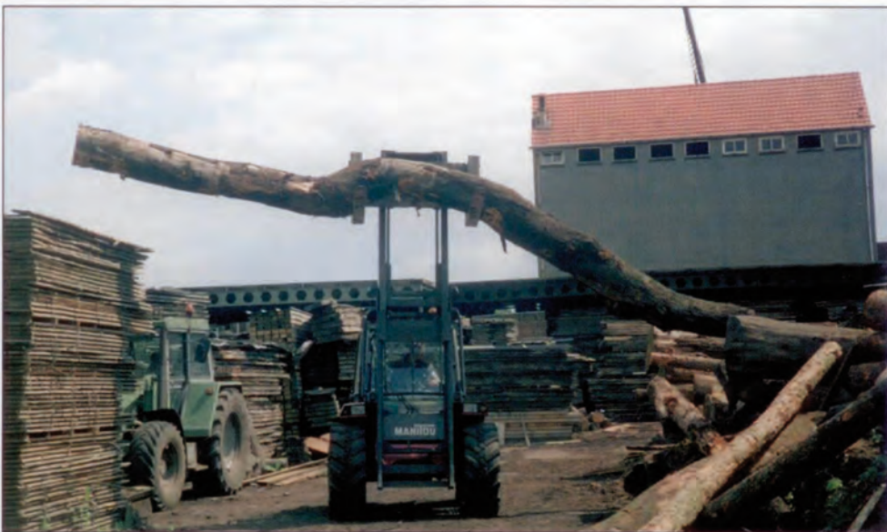
De eiken stam, waaruit de voorsteven gezaagd zal worden. Zagerij Oude Hengel, te Ootmarsum.
