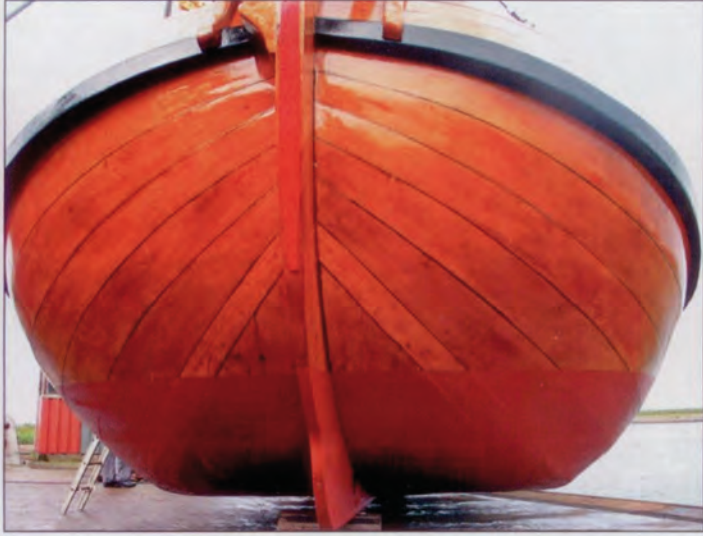
Een bolle kop. Het voorste punt van het berghout zit niet bij de steven, maar ter plaatse van de berentanden.
