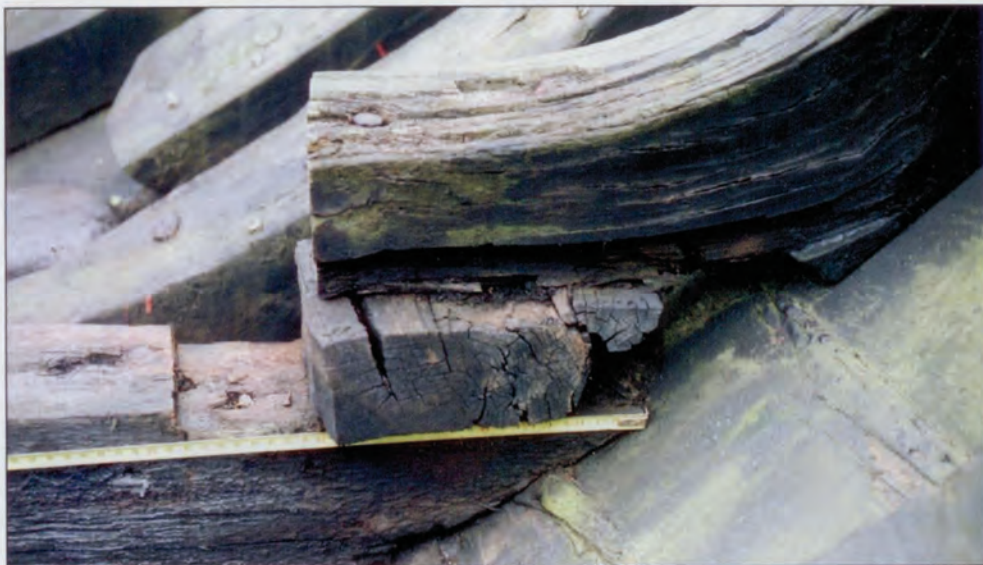
Achterste hoofdschot van het visbun, met een stukje dekenplank, en een restant dekenpoot. Belangrijke originele details voor de reconstructie van het visbun.
