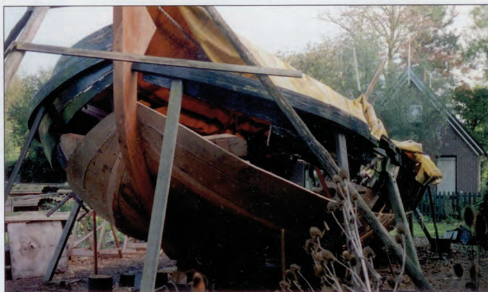
Vlakdelen en stevens zijn vervangen, evenals enkele huidplanken.
