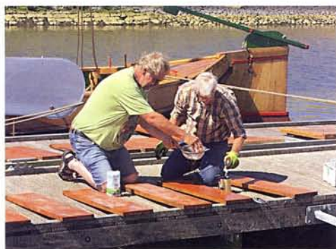
Anti-slip aanbrengen tijdens lakken van dekdelen
