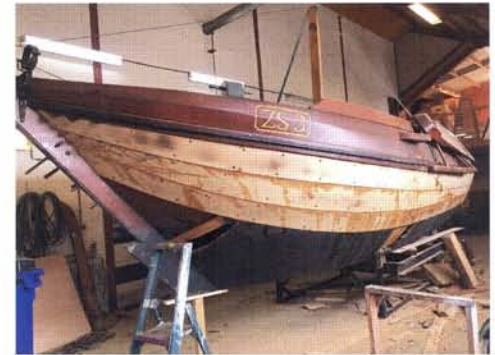
boven: Nieuwe steven en kielbalk zijn aangebracht
